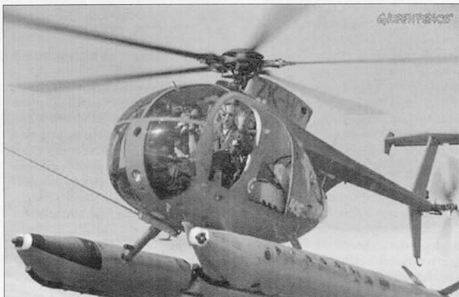
Greenpeace-pilote Paula Huckleberry in actie met haar "Twee-tie". De helicopter speelde een belangrijke rol bij het vastleggen van videobeelden van de acties bij het atol. De lange spriet onder de romp is de kortegolfantenne, welke lange-afstands communicatie mogelijk maakte. Foto (c) Greenpeace, Morgan.
